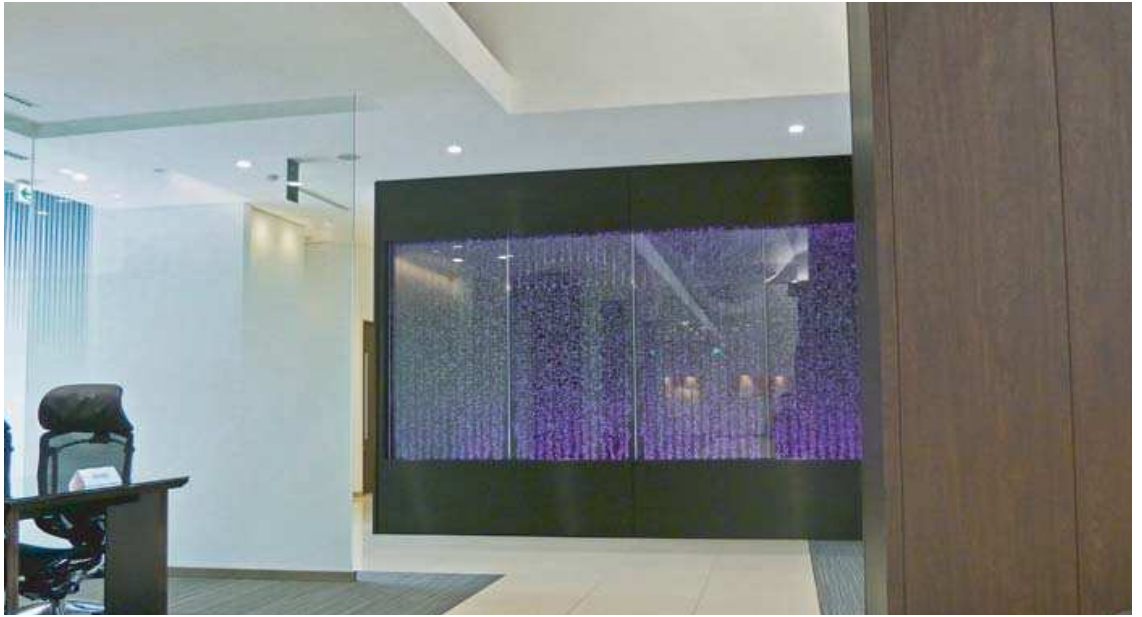
■ 事例：7 パネル背面に黒のバックパネルを配して泡を強調（東京都:店舗）
