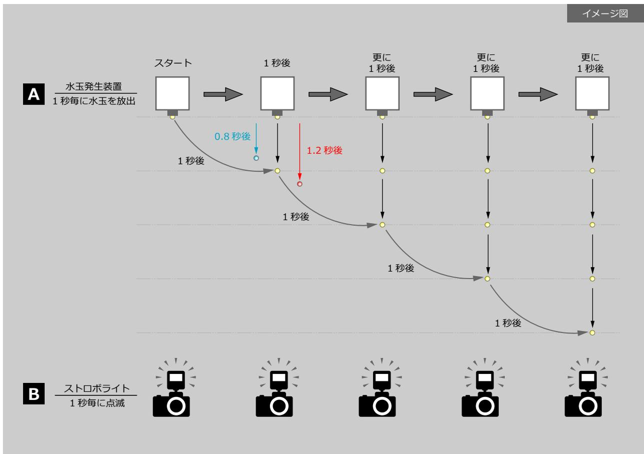
次にAの装置からは前回同様（暗闇状態で）1秒毎に天井から水滴を落とし、Bのストロボライトを先ほどより少し早いタイミング、例えば0.8秒毎に発光させるとどうなるでしょう？ 天井から落ちる水滴は少し早いタイミングで（天井に近い高さで）ライトに照らされて見えます。これを繰り返すと水滴はどんどん天井に近い状態でライトに照らされて見えるようになります。これがウォーターパール噴水で水が上昇して見える仕組みです。
